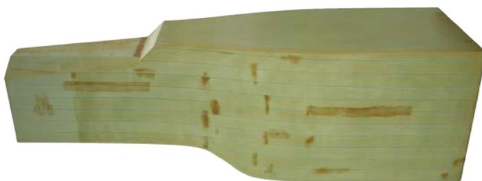
これはF4用の製造用モールドですが、全体的に抜き勾配を持った形状で、外側にプリプレグを巻きつけて成型後、型を抜き取る製法のため、御覧のようにシンプルな形状となっています。
