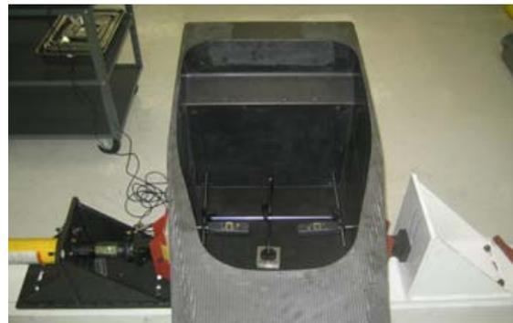
これらの試験はFIAの基準に準拠したモノコックの試験としては一般的な方法で、20kN負荷後、変位が20mm以下とか、荷重の除去後、永久変形が1mm以下とかの細かい基準が定められています。
